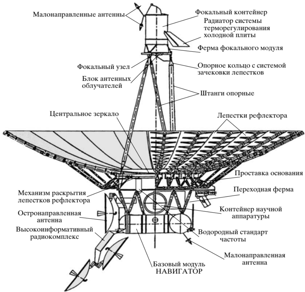
Рис. 1.7: Компоновка космического радиотелескопа РадиоАстрон [11].
